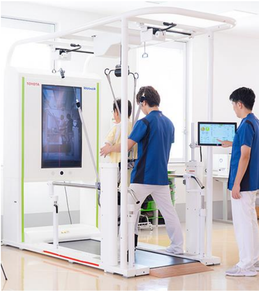
ロボット脚を使用した歩行特化リハビリテーション機器
